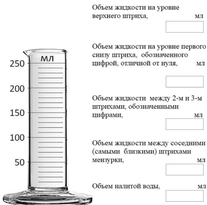
Рисунок 7.4. Пример раздаточного материала для виртуальной лабораторной работы «Определение цены деления измерительного прибора»
